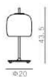
MT80532-1-200T 燈體尺寸：Φ20×43.5 功 率：LED 8W 材 質：銅+玻璃 顏 色：煙灰藍
