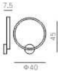
MB60168-1-450B 燈體尺寸：Φ40×45 功 率：LED 15W 材 質：鋁+亞克力 顏 色：美式淺古銅
