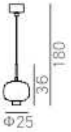
MD80560-1-250 灯体尺寸: \Phi 25 \times 180\text{cm} 功 率: LED 15W 材 质: 玻璃+洞石 颜 色: 氧化砂雾银
