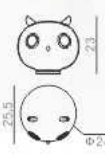
MT80530-1-230 燈體尺寸：24×25.5×23 功 率：E27 1 材 質：鐵+銅+玻璃 顏 色：馬斯登專用金
