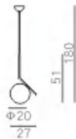
MD10563-1-300T 燈體尺寸：42×30×180 功 率：G9 LED 1×3.5W 材 質：銅+玻璃 顏 色：銅本色
