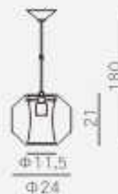
MD10811-1-240 燈體尺寸：Φ24×180 功 率：E27 1×40W 材 質：玻璃+石材 顏 色：雲石白
